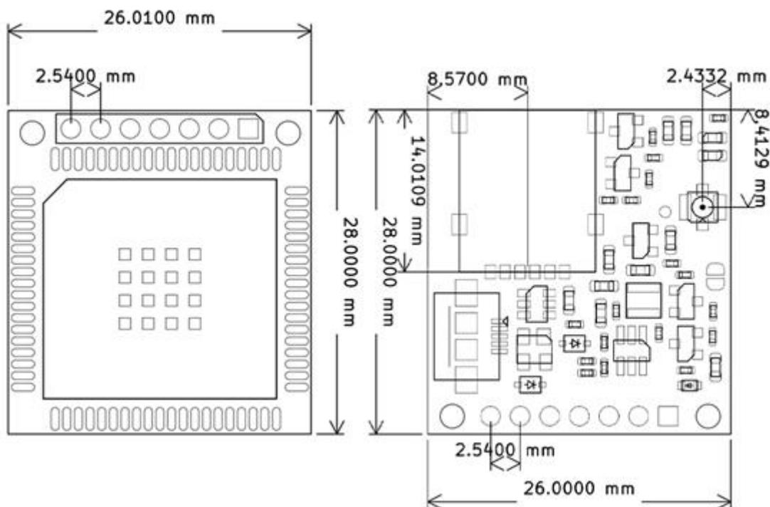
图 2 MD602 核心板结构尺寸图
