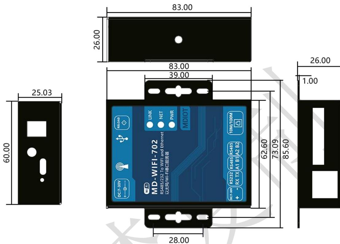
图 2 MD702 DTU 尺寸图
